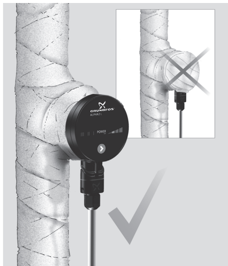
Рис. 6 Изоляция корпуса насоса
