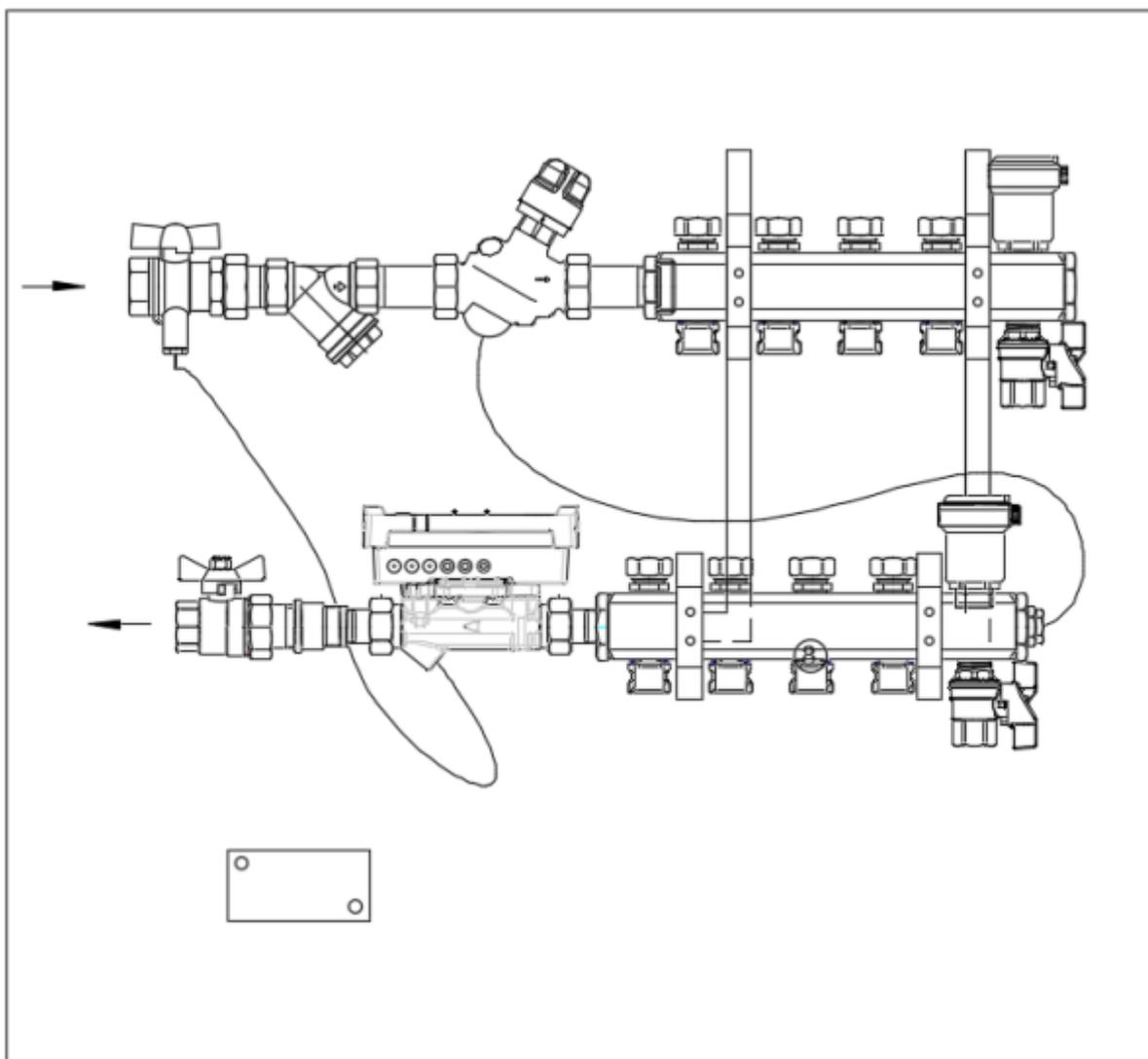
Шкаф с узлом присоединения квартирной системы отопления модификации ШКСО-1 предназначен для подключения к двухтрубной горизонтальной системе отопления. ШКСО-1 на 1 отвод для подключения к системе отопления с периметральной разводкой, ШКСО-1 на 2 и более отводов для подключения к системе отопления с лучевой разводкой. При применении шкафов с узлами присоединения квартирной системы отопления модификации ШКСО-1 выполняются присоединительная, измерительная, регулирующая и распределительная функции.
