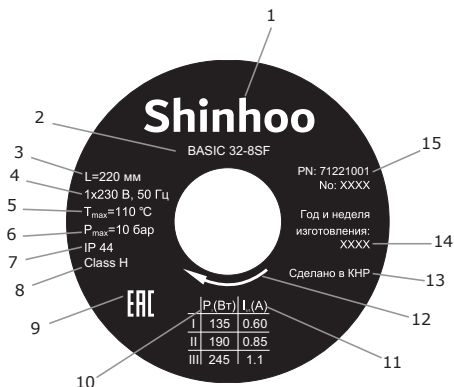
Рис. 1 Пример фирменной таблички BASIC
