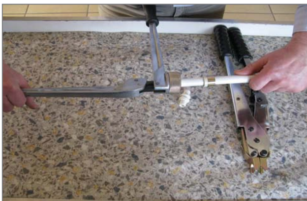
3. Расширьте трубу специальным расширителем (ручным или электрическим) за 3 последовательных расширения, повернув инструмент на около 15 - 30 градусов по оси трубы перед каждым расширением.
