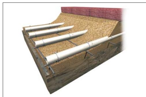
Напольное отопление на открытых пространствах
