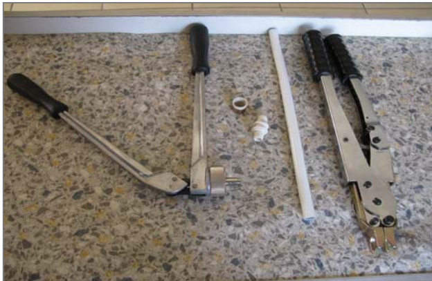
1. Отрежьте трубу и выберите нужный фитинг.
